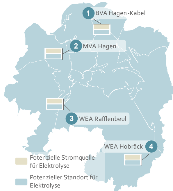
Abbildung 3-42: Übersicht der Projektansätze zur Wasserstoffherzeugung in Hagen
