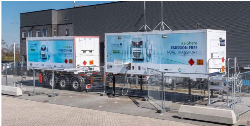
Abbildung 3-11: Beispiel für eine mobile Wasserstofftankstelle, Quelle: Wystrach
